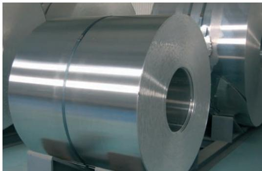
Die Bandstreckrichtanlage (BSTRA) dient der speziellen Behandlung von Bunden. Dabei wird das hochwertige Material der Anlage in Form von so genannten „Coils“ – hier im Bild - mit zwei Meter Durchmesser, einer Breite von 1,7 Meter und einem Gewicht von nahezu acht Tonnen zugeführt.
