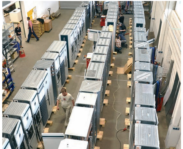
Erster Großauftrag des Jahres: 63 NSHV-Sivacon-S8-Felder bis 4.000A wurden ab Mai innerhalb von sechs Wochen für das Siemens Data Center München angefertigt.
