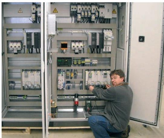
Schaltanlagenprüfer Christoph Neumayr bei der Prüfearbeit an einer Standard-Schaltanlage, welche die Firma Resch für eine Garnveredelungsmaschine eines US-Kunden benötigt.
